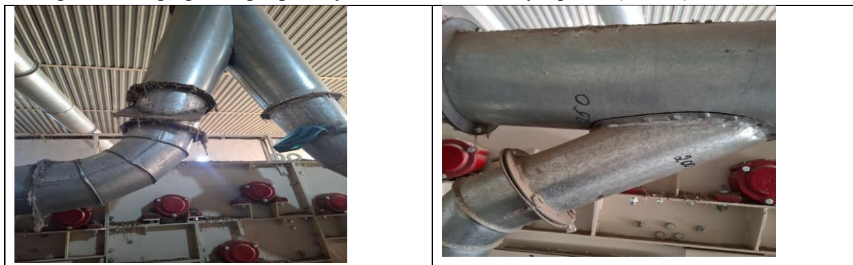
2-rasm. UXK paxta tozalash agregatining takomillashtirilgan aspiratsiya tizimi ko'rinishidan lavhalar
